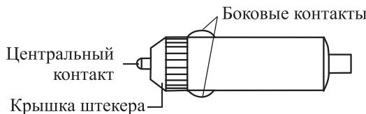
2. Установите новый предохранитель (предохранитель не имеет полярности, поэтому вы можете установить его любым концом внутрь). Технические характеристики предохранителя: 10 A, 250 В, длина 20 мм и диаметр 5 мм.
