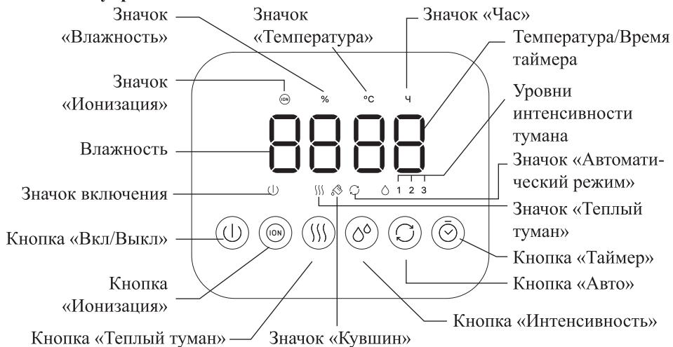
Управление увлажнителем происходит сенсорными кнопками на основании увлажнителя или пультом дистанционного управления (пульт ДУ). Кнопки на пульте ДУ дублируют кнопки на основании устройства. Пульт работает от 1 батарейки типа CR2025 (входит в комплект). Пульт ДУ нужно направлять на дисплей увлажнителя.
