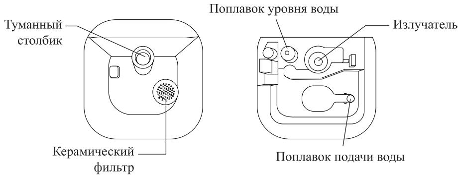
Когда воды в основании увлажнителя нет или недостаточно, **поплавок уровня воды** опускается вниз и увлажнение останавливается. Добавьте воду в резервуар, увлажнитель продолжит работать в установленном режиме.
