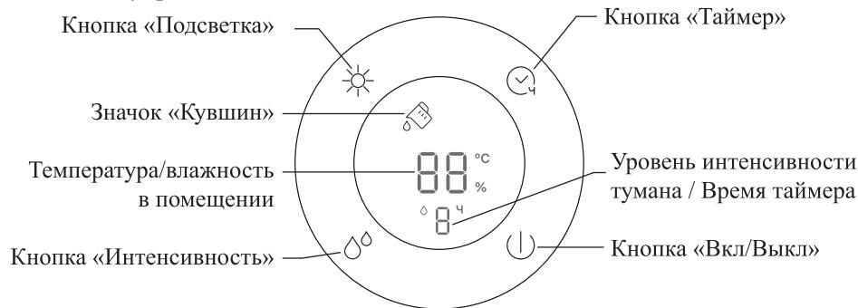
Управление увлажнителем происходит сенсорными кнопками или пультом дистанционного управления (пульт ДУ). На дисплее отображаются температура и влажность в помещении, уровень интенсивности тумана и время таймера, значок «Кувшин».
