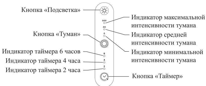
На панели управления находятся сенсорные кнопки и индикаторы. Подключение к сети и нажатие на кнопки сопровождается звуковым сигналом.
