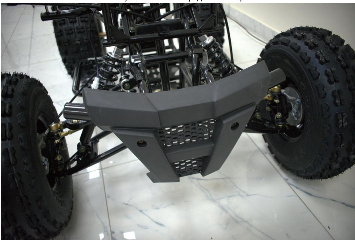
11 устанавливаем передний бампер
