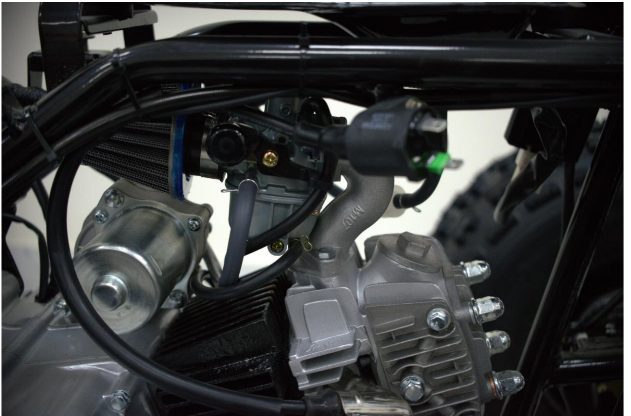
13 устанавливаем карбюратор и фильтр
