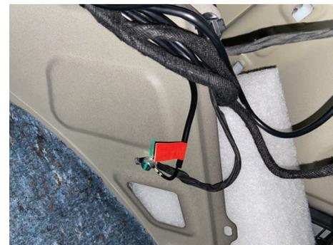
**16** Соберите и закрепите излишки жгутов проводов. Подключите провод GND к кузову автомобиля под ближайший болт.
