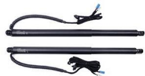
1 Электроприводы двери багажника (амортизаторы).
