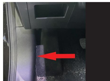
**18** За декоративной накладкой возле площадки для левой ноги водителя в жгуте проводов подключите к CAN-шине автомобиля.
