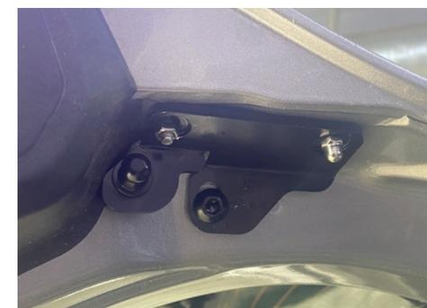
**4** Установите новые кронштейны из комплекта на кузов и дверь багажника.
