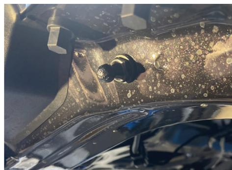
**3** Демонтируйте оригинальные кронштейны, на которые был установлен оригинальный амортизатор и пластиковые гайки крепления спойлера.
