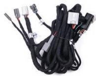
11 Основной жгут подключения компонентов в двери багажника.
