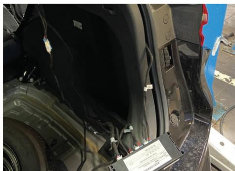
**14** Подключите к блоку управления все ранее выведенные жгуты проводов левого и правого амортизатора и провода жгута из двери багажника. Подключите к блоку провода жгутов питания, CAN-шины и салонной кнопки открывания багажника.
