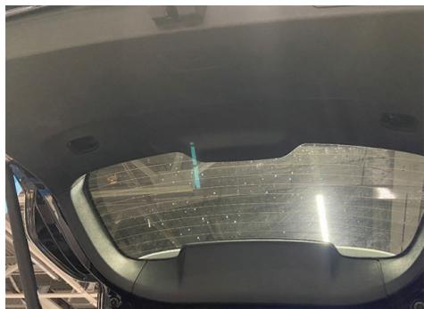
Обратите внимание, что один амортизатор может не удержать крышку багажника. Либо воспользуйтесь помощью человека, либо зафиксируйте дверь при помощи подпорки.
