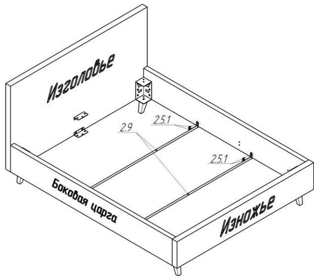
Рисунок 5 – Установка нижних стяжек в основание кровати
