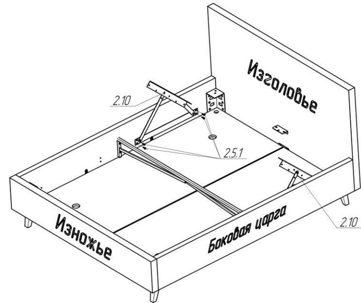
Рисунок – 7 Каркас кровати с подъёмным механизмом
