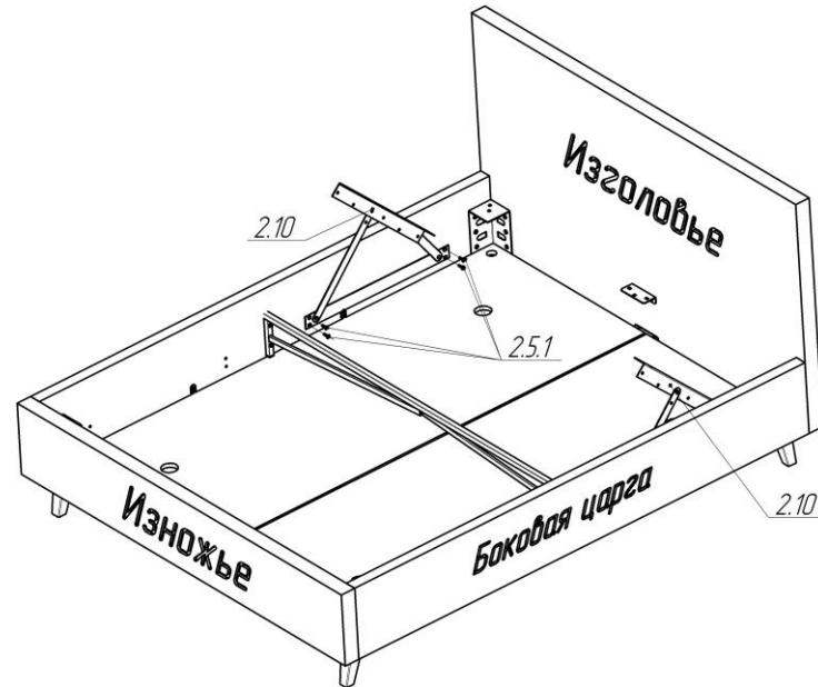
Рисунок – 7 Каркас кровати с подъёмным механизмом
