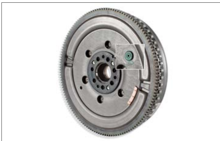
Рисунок 1: Двухмассовый маховик LuK со стопорным штифтом в качестве транспортного зажима.
