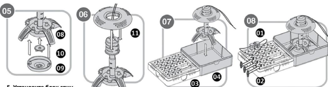
5. Установите блок спиннинга (10) снизу основания фонтана (8). Затем закрепите замок для базы фонтана (9) и защелкните ее.
