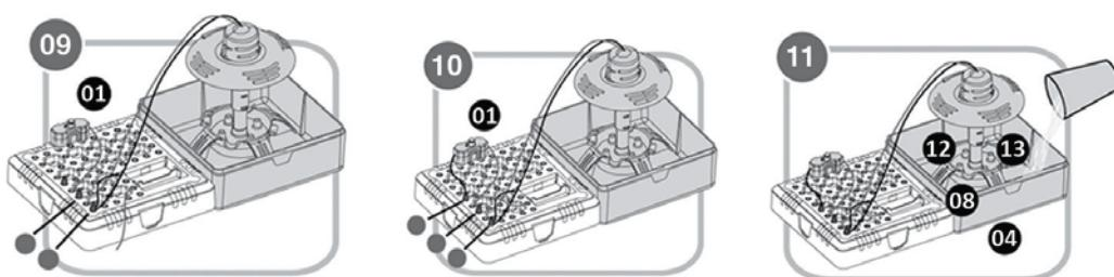
9. Подключите черный провод от батареи и черный провод от фонтана к соединителю (a). Затем подключите красный провод от фонтана к соединителем (b). Красный провод включателя подключите к соединителю (b).
