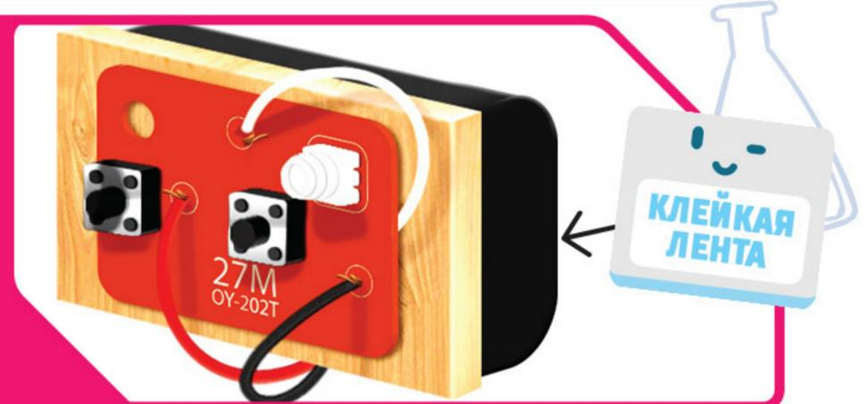
Соедините красный провод радиомодуля с красным (+) проводом отсека для батареек, чёрный провод радиомодуля с синим (-) проводом отсека для батареек.
