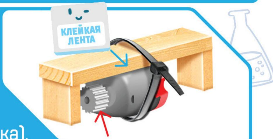
Приклейте «полочку» с моторчиком снизу к нашей машинке в передней части так, чтобы маленькая шестерёнка оказалась в контакте с большой шестерёнкой на передней оси машинки.
