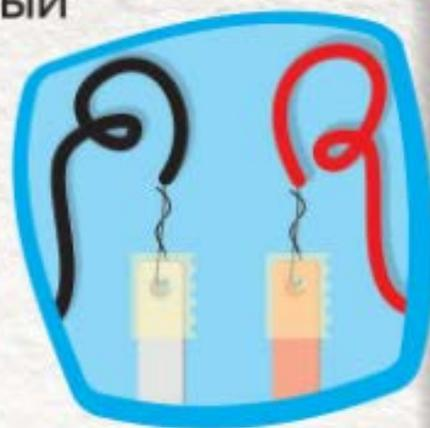
**3** Вставь медные и цинковые пластины в картофель, как показано на схеме. Смотри, чтобы металлические пластины не соприкасались друг с другом. Если всё сделано аккуратно, часы должны начать работать.
