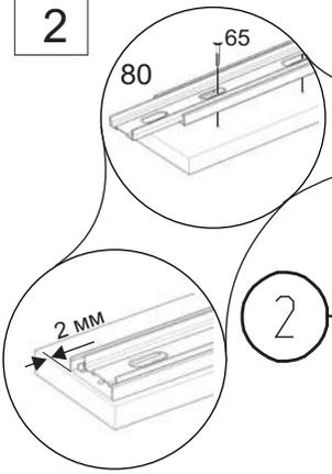
Во избежание потертостей деталей монтаж фурнитуры производить на любом предохранительном материале
