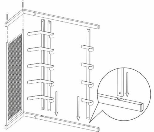
**3** УСТАНОВИТЕ ЗАКЛЁПКИ В ОТВЕРСТИЯ НА ОБОРОТНОЙ СТОРОНЕ ВЕШАЛКИ ДЛЯ ФИКСАЦИИ.
