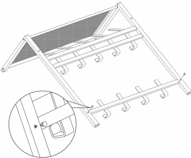
**4** ПРИЛОЖИТЕ СОБРАННУЮ ВЕШАЛКУ С ПОЛКОЙ К СТЕНЕ, ВЫРОВНЯЙТЕ ПО УРОВНЮ И ОТМЕЬТЕ МЕСТА КРЕПЛЕНИЯ ЧЕРЕЗ СКВОЗНЫЕ ОТВЕРСТИЯ. СДЕЛАЙТЕ ОТВЕРСТИЯ И ЗАКРЕПИТЕ ВЕШАЛКУ КРЕПЕЖОМ, ПОДХОДЯЩИМ ДЛЯ ВАШЕЙ СТЕНЫ. ЗАКРОЙТЕ ОТВЕРСТИЯ ДЕКОРАТИВНОЙ ЗАГЛУШКОЙ.
