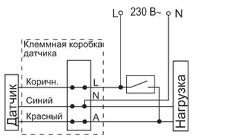
При включении выключателя датчик движения шунтируется, и на нагрузку подается напряжение.
