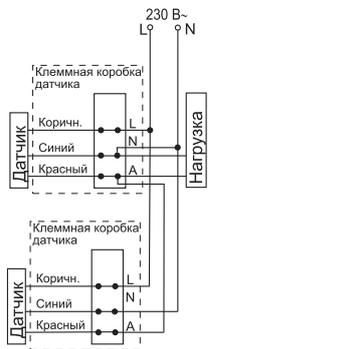
При срабатывании любого датчика цепь замыкается, и на контакты нагрузки подается рабочее напряжение.
