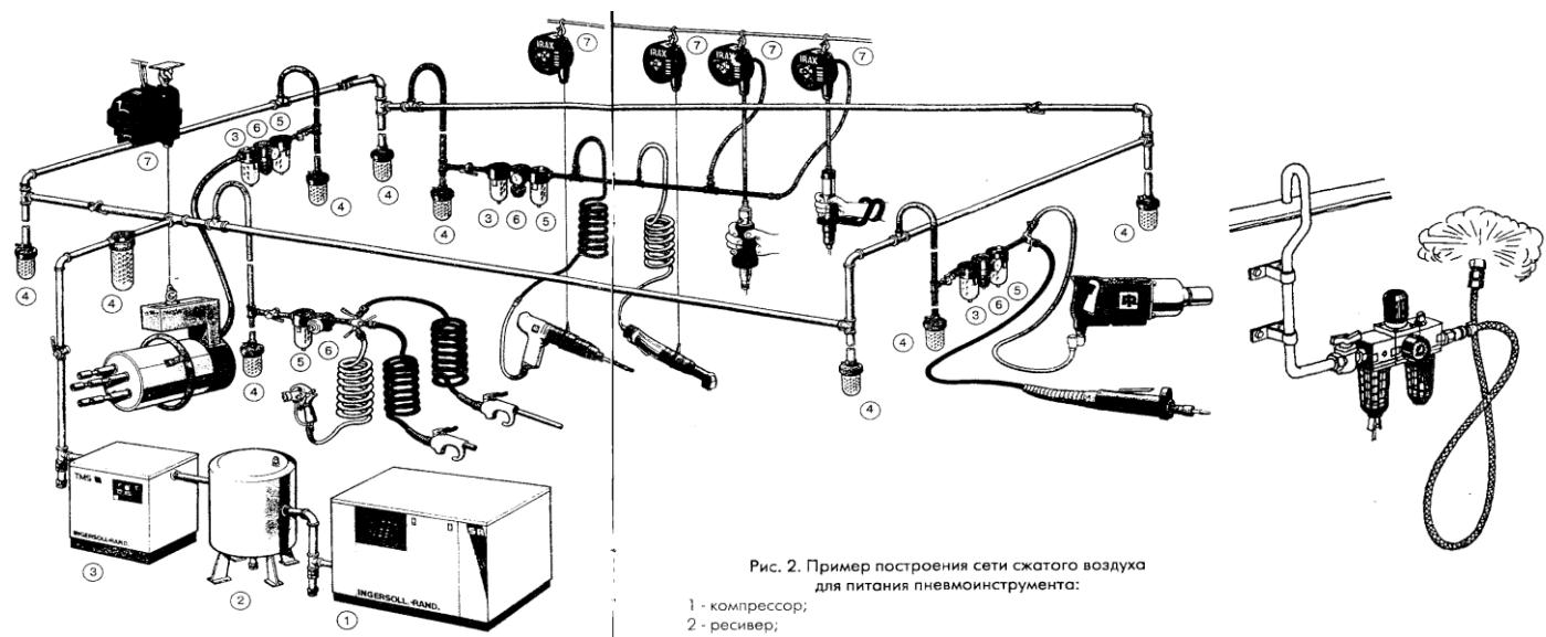
Рис. 2. Пример построения сети сжатого воздуха для питания пневмоинструмента:
