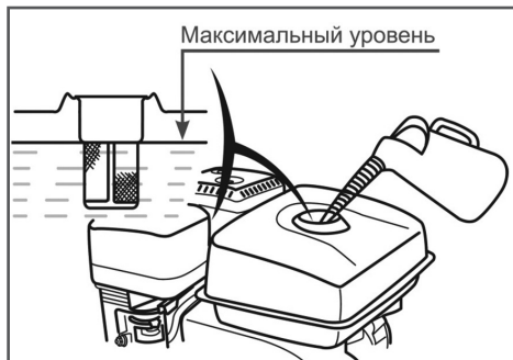
Рис. 22 Максимальный уровень топлива в топливном баке
