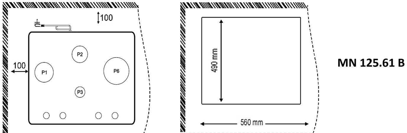
Внешние размеры, указанные цифрами, определяют стандартные размеры плиты на столешнице. После того, как столешница подготовлена, обратитесь в обслуживающий центр для установки плиты. Позвоните в уполномоченный сервисный центр.
