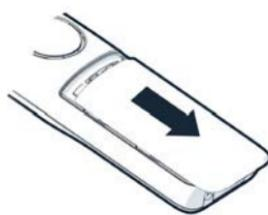
Снятие крышки аккумуляторного отсека
