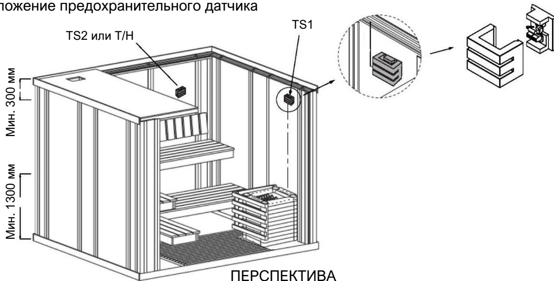
Рис. 7. Расположение предохранительного датчика
