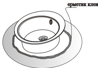
**ВНИМАНИЕ! Перед установкой изделия на кухонную тумбу необходимо смонтировать перелив и сифон согласно схеме (см. ниже); важно подрезать соединительные трубки до нужной длины:**
