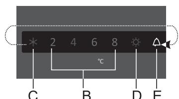
При превышении допустимой температуры в приборе включается прерывистый звуковой сигнал и мигает индикатор **E**.
