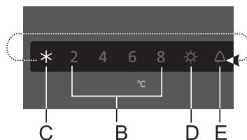
Чтобы включить функцию «Интенсивное охлаждение», нажмайтe кнопку **A**, пока не загорится индикатор **C**.
