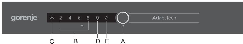
**A Кнопка вкл./выкл. прибора, установки температуры и дополнительных функций**
