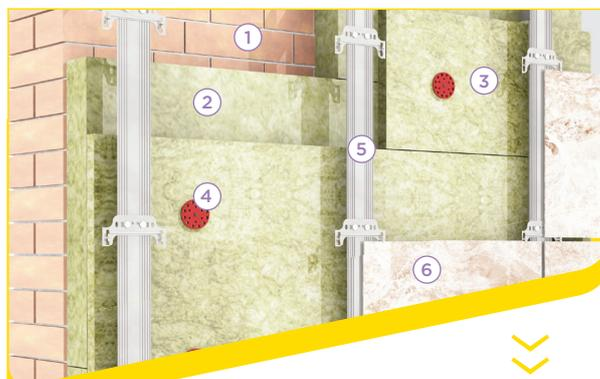
1. Несущая или самонесущая стена (основание: кирпич, бетон, пеноблок).
