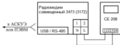
Рисунок 13 Схема подключения счетчика через PLC-интерфейс
