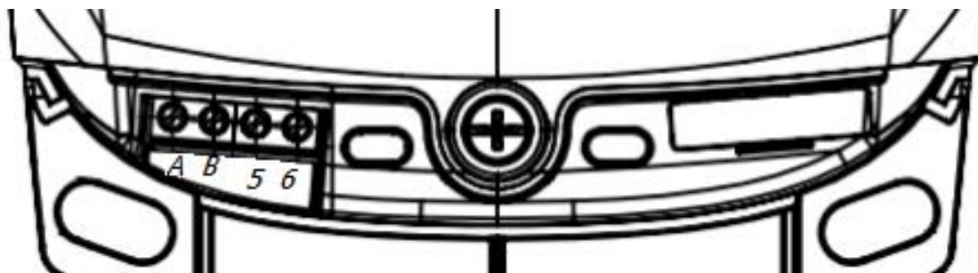
Рисунок 5. Обозначение функциональных контактов счетчика S51, S53 исполнения с RS-485
