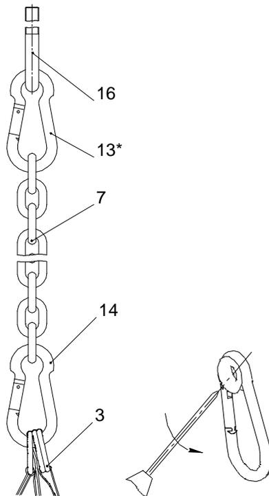
\* - из карабина 13 предварительно снимите пластиковый элемент.
