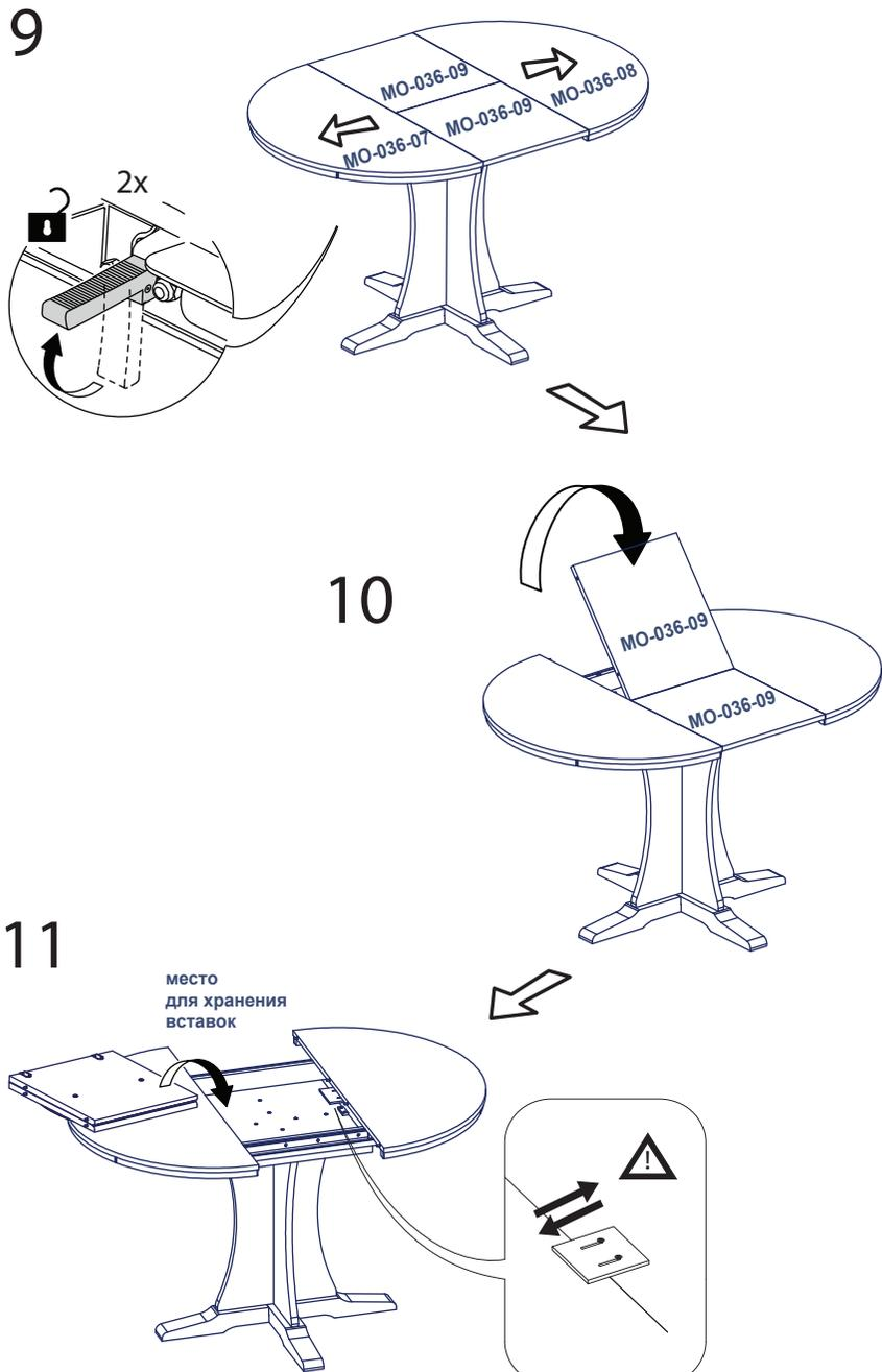
Для удобства установки вставок при раскладывании стола использовать выдвигающую планку в качестве опоры.
