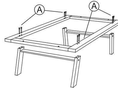
4) Соединить задний борт (6) и ложе (8) с боковинами (5) с помощью евровинтов (А)
