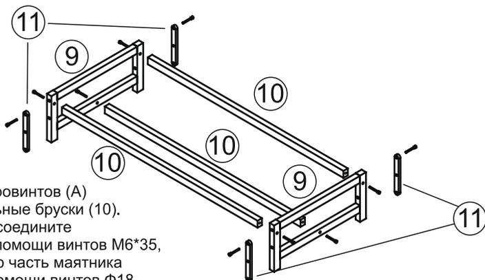
Соедините при помощи евровинтов (А) две боковины (9) и продольные бруски (10). На полученный каркас присоедините рычаги маятника (11), при помощи винтов М6\*35, (механизм качания), вторую часть маятника присоедините так же при помощи винтов Ф18, к нижней части ног кровати, к уже впрессованному забивным гайкам.
