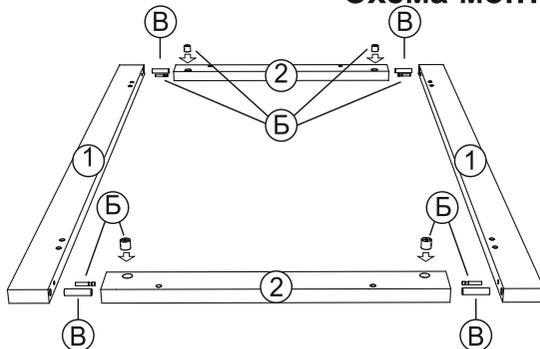
1) Собрать основание кровати соединив продольные бруски основания (1) с поперечными брусками основания (2) при помощи шкантов (В) и эксцентриковой стяжки (Б).
