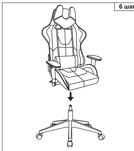
Внимание! Шаг 1. Снять защитный колпачок с газлифта, в случае его наличия.
