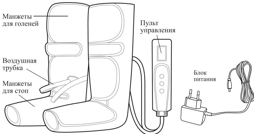
Принцип действия прессотерапии основан на подаче сжатого воздуха низкого и высокого давления через манжеты. Воздействие сжатым воздухом осуществляется с перерывами. Так же процедуру в любой момент можно прервать с помощью кнопки на пульте управления. Это важно, когда будете выбирать силу сжатия.
