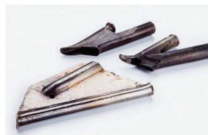
Насадка 5 мм зауженная Для сварки ПВХ покрытий.
