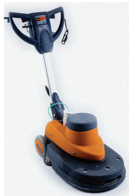
Шлифовальная машина Для шлифовки основания.
