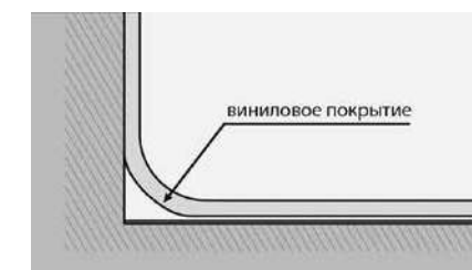
Рис. 50. Для укладки на угол покрытие обрабатывается строительным феном и плотно прижимается к углу между полом и стеной с помощью ролика
