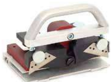
Линокат Отрезает верхний край материала, используя при этом нижний как базу. Два лезвия позволяют резать без линейки от стены к стене
