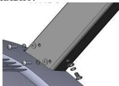
**Шаг 2:** Установите на стойки консоль тренажёра, закрепите её при помощи двух винтов M10\*20 ① и двух шайб ⑤.
