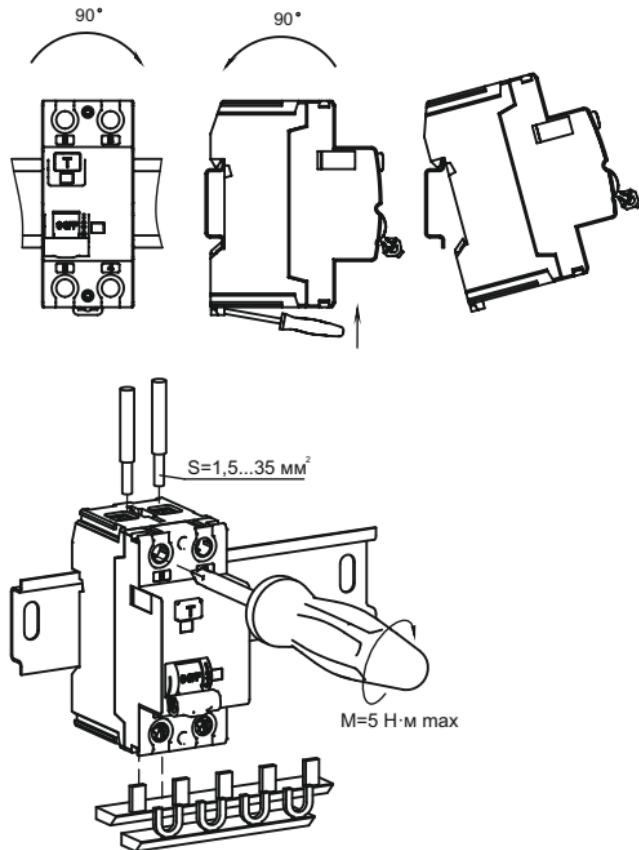
После монтажа и проверки его правильности, подают напряжение электрической сети на электроустановку и включают ВДТ переводом рукоятки управления в положение «I» – «ВКЛ», нажимают кнопку «ТЕСТ». Немедленное срабатывание ВДТ (отключение защищаемой устройством цепи и желтый цвет индикатора срабатывания от дифференциального тока) означает, что он работает исправно.
