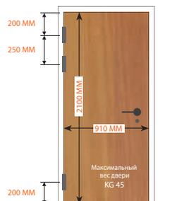
Дверь на 2 или 3 петли. Вес двери распространён равномерно, и установка произведена в соответствии с технической схемой.
