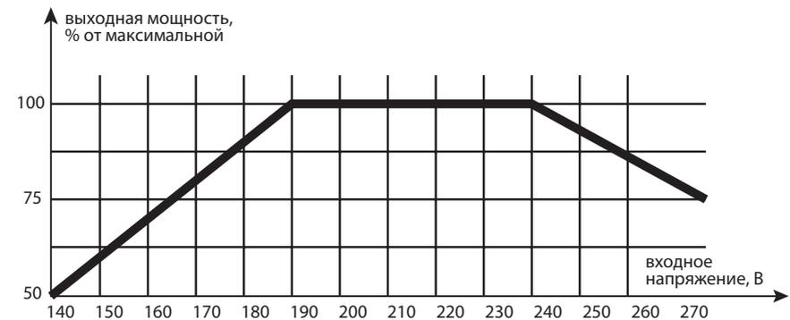
спортивную потребляемую мощность двигателя необходимо умножить минимум на 3, во избежание перегрузки стабилизатора напряжения в момент включения устройства. Большие пусковые токи могут наблюдаться и у других устройств.
