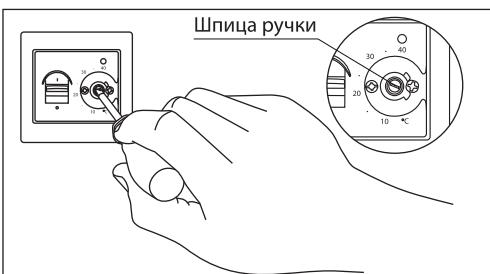
3. С помощью отвертки плавно поворачивайте шлицу ручки (как показано на рисунке), пока не загорится светодиодный индикатор. Запомните (или запишите) значение температуры в момент включения индикатора.
