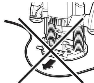
Избегайте попадания сетевого кабеля в зону работы фрезы
