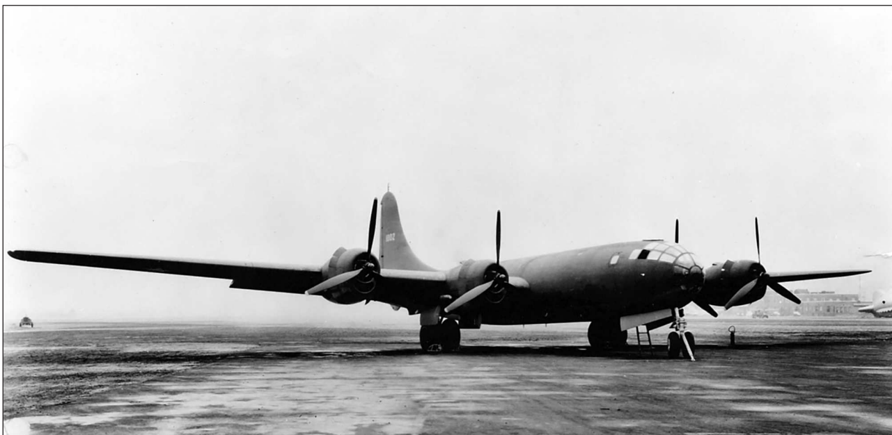
Первый прототип XB-29-BO (41-002). 23 сентября 1942 г. через два дня после первого полёта. Самолёт был окрашен в нейтрально-серый цвет снизу и в оливковый цвет на остальных поверхностях. Самолёт имел трёхлопастные винты фирмы Гамельтон Стандарт Гидроматик диаметром 5,8 м. В дальнейшем, в серии, самолёты имели только четырёхлопастные пропеллеры той же фирмы
