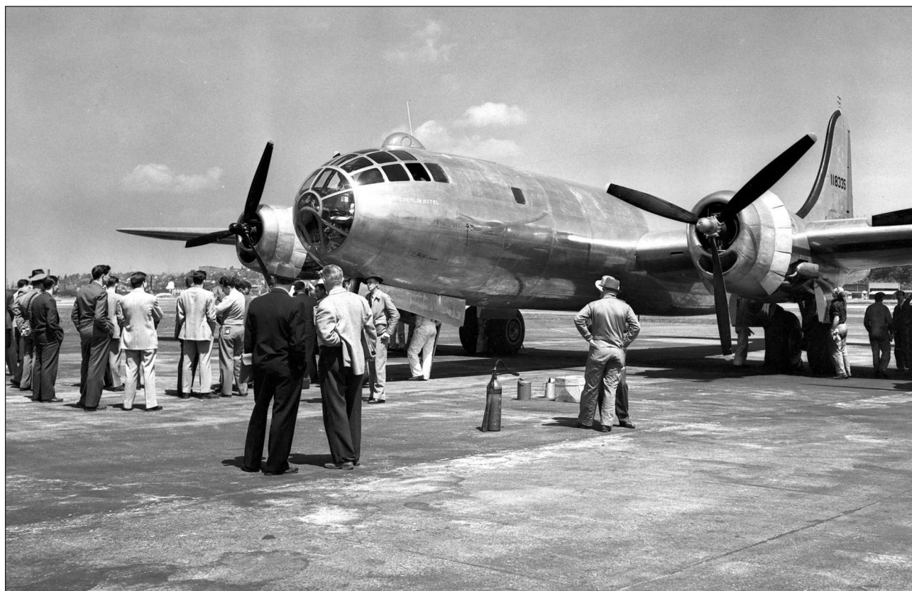
Третий прототип XB-29 (41-18335). Самолёт не окрашен и имеет трёхлопастные пропеллеры. Хорошо виден обтекатель пеленгатора над кабиной пилотов. На переднем плане — огнетушитель
