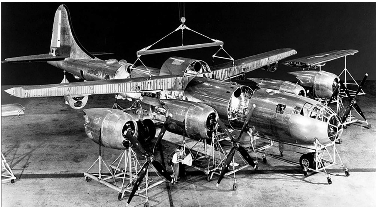
Конструктивно-технологическое членение самолёта В-29. Постановочный кадр. Такого рода фото использовались для обучения персонала
