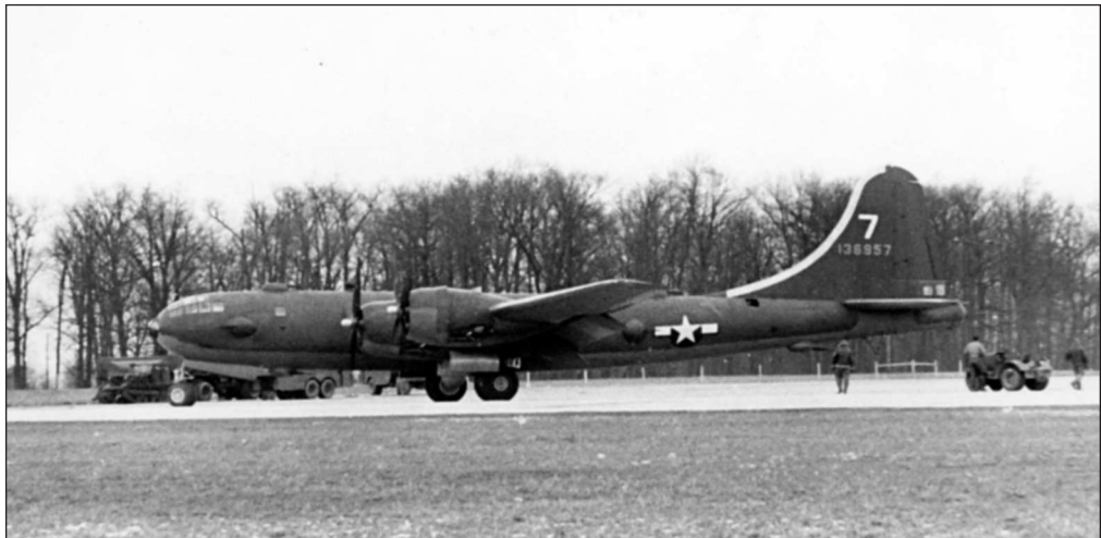
Предсерийный YB-29 (41-36857) с комплектом оборонительного вооружения. Самолёт имеет пулемёты для стрельбы вперёд, от которых в дальнейшем отказались
