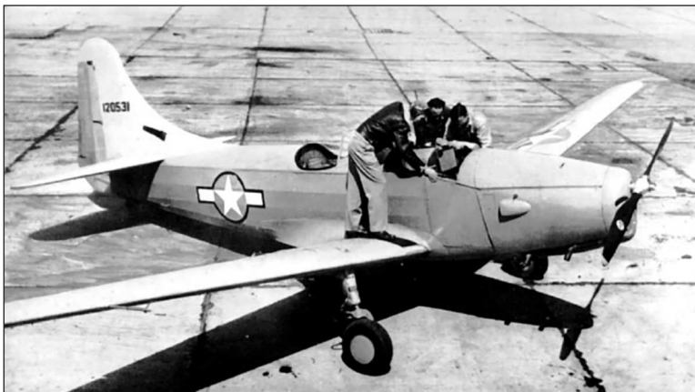
Самолёт Фэйрчайлд РТ-19, на который были установлены крыло и оперение с профилями, аналогичными профилям самолёта В-29. На этом самолёте специалисты Боинга проводили лётные испытания аэродинамической компоновки Суперфортресса
