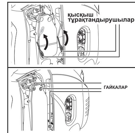
Ауа сүзгішінің 1 корпусын шешініз: тек қана **ЗИГ-1200 үшін** – қысқыш тұрақтандырушыларды шешініз; **ЗИГ-1200 баскасы** – бекітілген арқылы бұрап алыңыз. Сүзгіш қақпағын шешініз, сузетін элементті босатыңыз және оның ластануын сырттай бақылау арқылы қараңыз.
