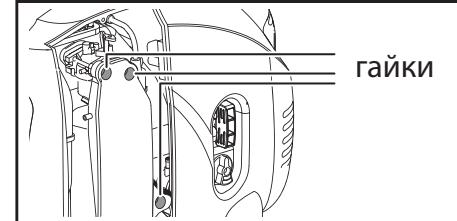
Снимите корпус **1** воздушного фильтра: **только для ЗИГ-1200** - поднимите пружинные фиксаторы; **кроме ЗИГ-1200** - отверните гайки крепления. Снимите крышку фильтра, извлеките фильтру-
