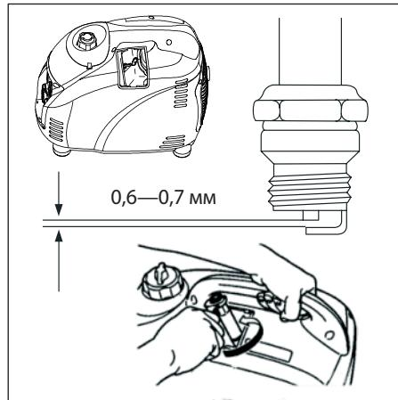
Зазор между электродами должен составлять 0,6–0,7 мм.
