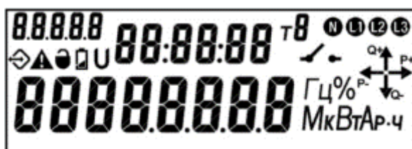
Рисунок 160 – Тестирование сегментов ЖКИ.
