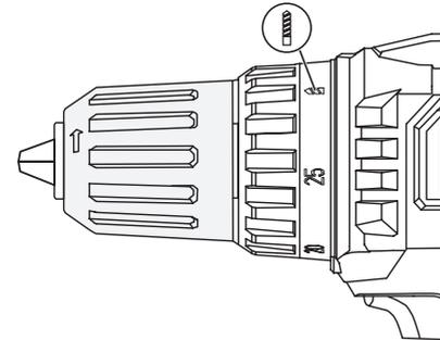
Во избежание травм, не заворачивайте шурупы в положении
