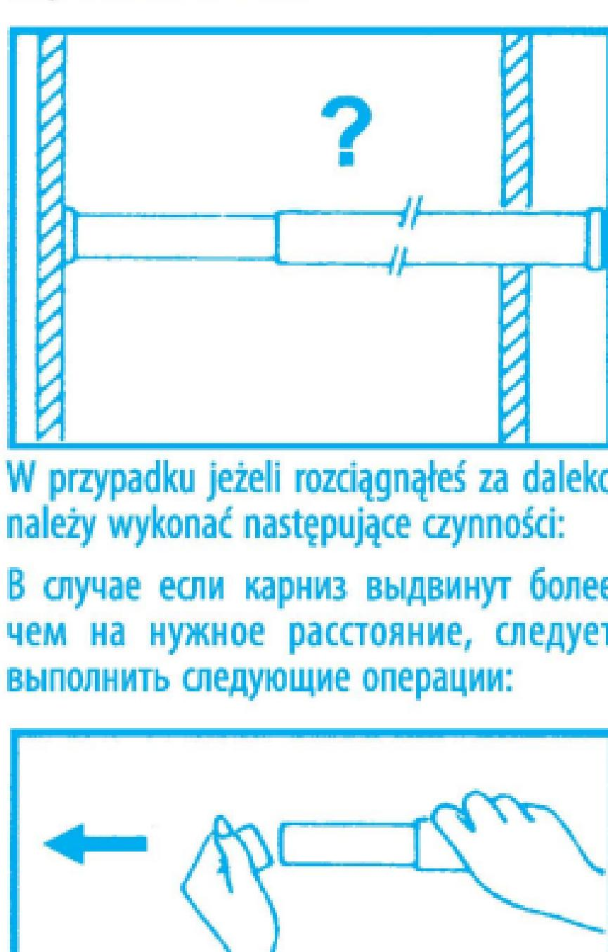
Rys. 2. Rozsunąć drążek na wymiar „x”+3cm.
