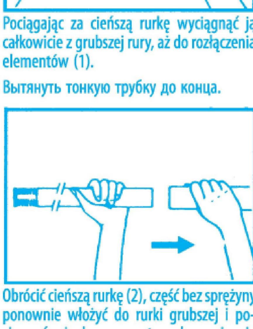
Pociągając za ciejszą rurkę wyciągnąć ją całkowicie z grubszej rury, aż do rozłączenia elementów (1).
