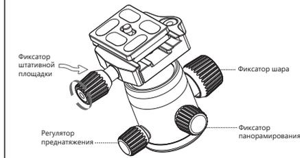
Система быстросъемной штативной площадки оснащена предохраняющим устройством от случайного выскальзывания камеры
