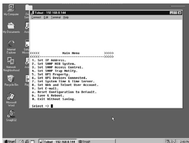
Рис.61 Окно NetAgent Telnet
