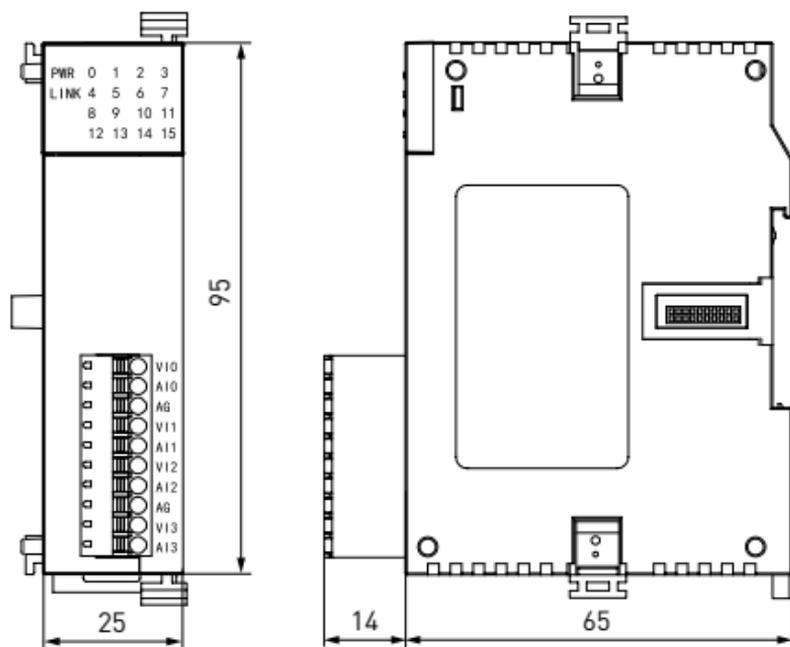
Рисунок 2 – Габаритные размеры модуля аналогового ввода/вывода
