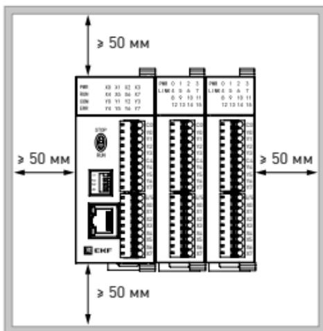
Подключение питания, входных и выходных сигналов осуществляется с помощью зажимных клемм под максимальное сечение провода 1 мм<sup>2</sup>.
