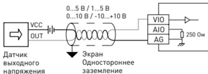
Трехпроводная схема подключения
