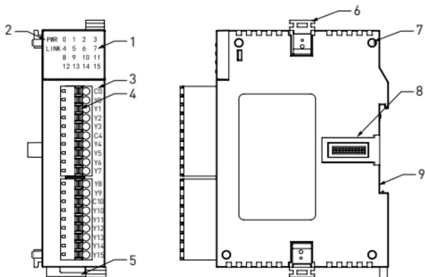
Рисунок 3 – Основные элементы модуля дискретного ввода/вывода
