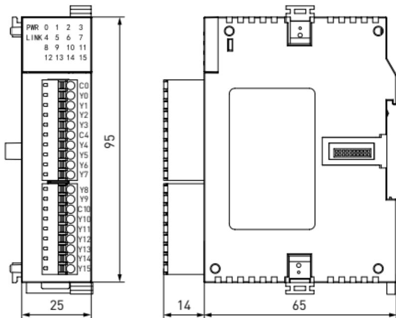
Рисунок 1 – Габаритные размеры модуля дискретного ввода/вывода
