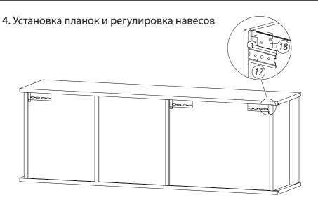
Закрепите планки для навешивания (17) на стене. Навесьте шкаф на планки, отрегулируйте его по высоте при помощи нижних регулировочных винтов на навесах (18), с помощью второго винта на навесах притяните шкаф к стене и установите декоративные заглушки на навесы.
