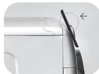
Если вы не знаете, где размещена антенна NFC на смартфоне, слегка перемещайте его круговыми движениями вокруг логотипа Smart Fi+, до тех пока Приложение не подтвердит соединение. Для успешной передачи данных **ОЧЕНЬ ВАЖНО ДЕРЖАТЬ СМАРТФОН НА ПАНЕЛИ УПРАВЛЕНИЯ СТИРАЛЬНОЙ МАШИНЫ В ТЕЧЕНИЕ ВСЕХ НЕСКОЛЬКИХ СЕКУНД, КОГДА ИДЁТ ПЕРЕДАЧА ДАННЫХ**. Сообщение на смартфоне проинформирует Вас о правильном завершении процедуры и моменте, когда смартфон можно убрать.
