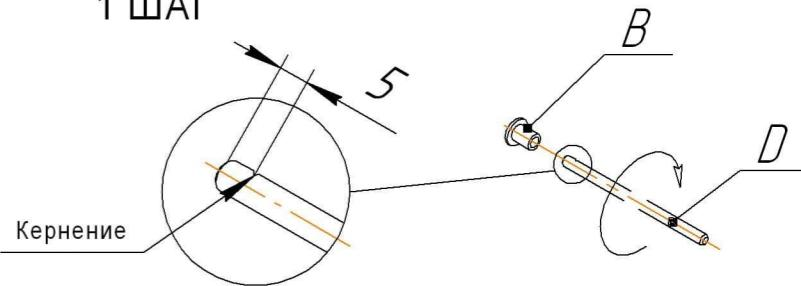
Вкрутить шпильку поз.Д концом с кернением до упора.
