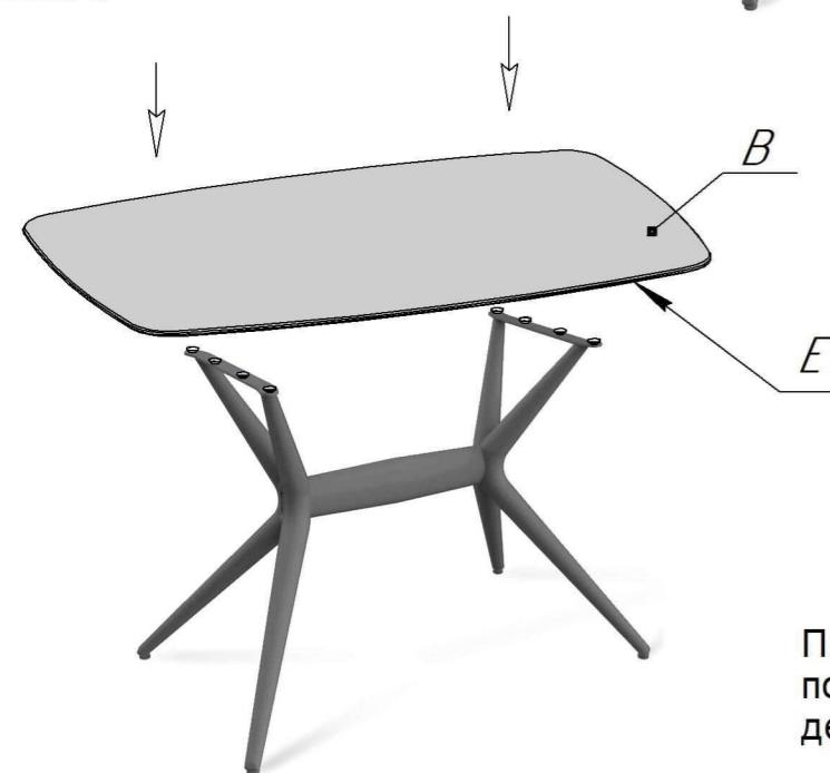
Перед установкой столешницы, обезжирить поверхность Е детали поз.В и поверхность F деталей С.
