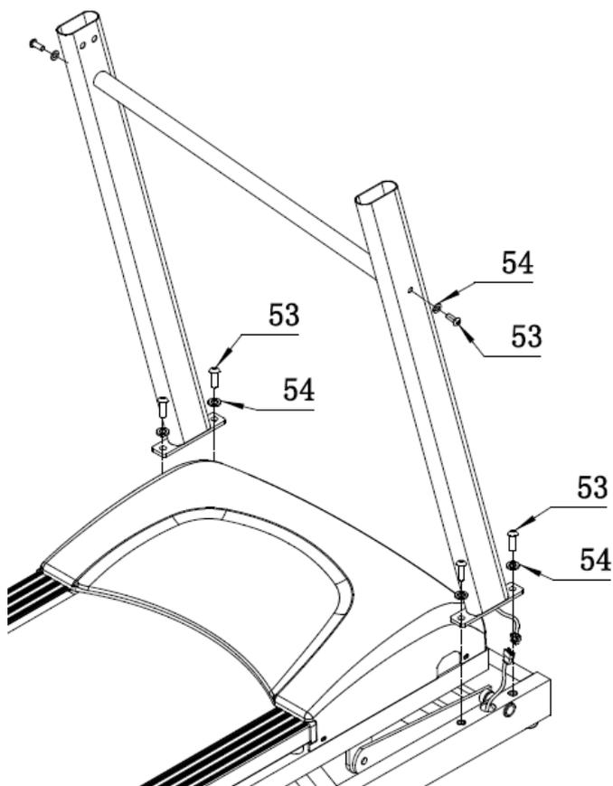
Сначала зафиксируйте поперечину на стойках с помощью болта M10 \* 20 (53) и шайбой Ø10 (54)
