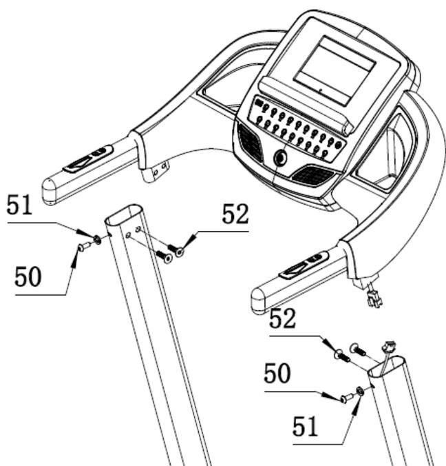
Закрепите консоль на стойках консоли при помощи шайбы Ф8 (51), болта М8\*30 (50) и болта М8\*20 (52).
