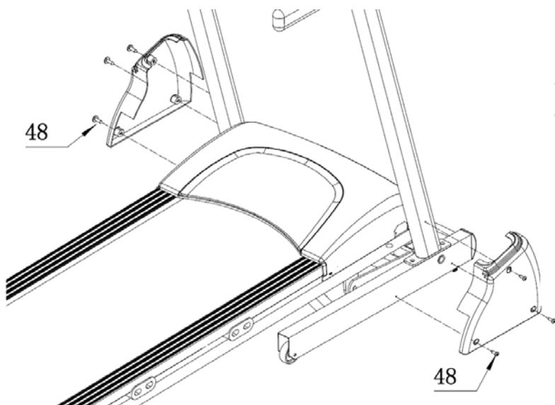
Закрепите кожух стойки консоли на стойке консоли с помощью винтов ST4.2 \* 15 (48)
